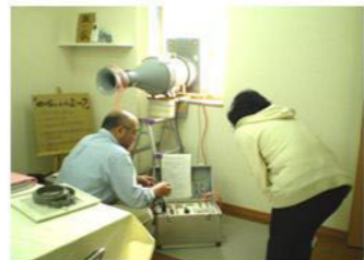
お引渡しの前には、施主様立会いのもと、気密つまり隙間がない工事をしているかどうかの測定をします。相当隙間面積:0.5cm 2 /m 2 でした。
